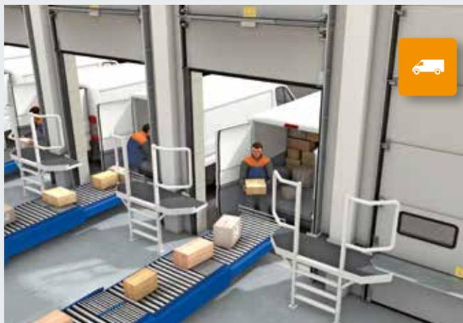
I furgoni vengono caricati allo stesso livello del pavimento del capannone. Il portone si apre completamente, incluso lo zoccolo pannelli
